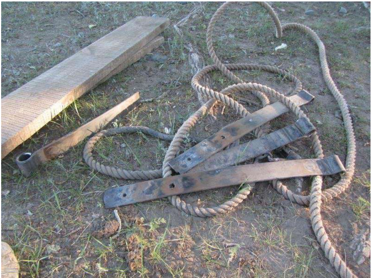
Пресловутые рессоры Форда. (прожжено отверстие для болта)
